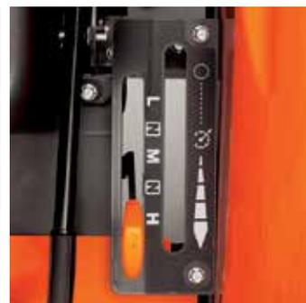
*Leva per il cambio di gamma e regolazione della velocità*
