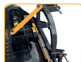
Spostamento laterale meccanico Mechanical lateral displacement
