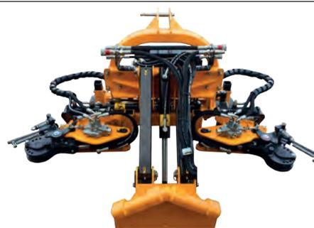
Necessita di una coppia di prese idrauliche con 30 lt/min di olio.
