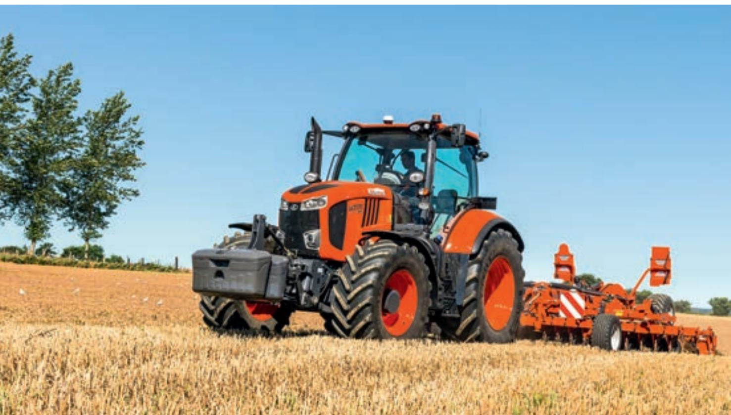
L'incredibile capacità di sollevamento dell'M7001, pari a 9400 kg, permette di operare rapidamente con abbinamenti di seminatrici ed altre attrezzature pesanti, quali aratri, coltivatori e simili. Il sollevatore anteriore con capacità di 3900 kg offre una capacità aggiuntiva di
