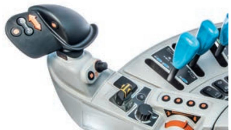
Alcuni comandi aggiuntivi sono centrati sul lato destro in tutti i modelli del trattore M7001. Il modello Standard ha un bracciolo rigido con la leva multifunzione, mentre i modelli avanzati sono dotati di un bracciolo moderno che comprende la leva multifunzione.
