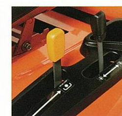
Leva di sollevamento idraulico del piatto
