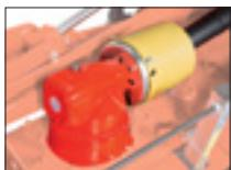
Riduttori laterali monovelocità e alberi cardanici con limitatore a bullone
