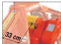
Riduttore cambio con PTO arretrato a 2+4+2 velocità per 540/750/1000 g/min
