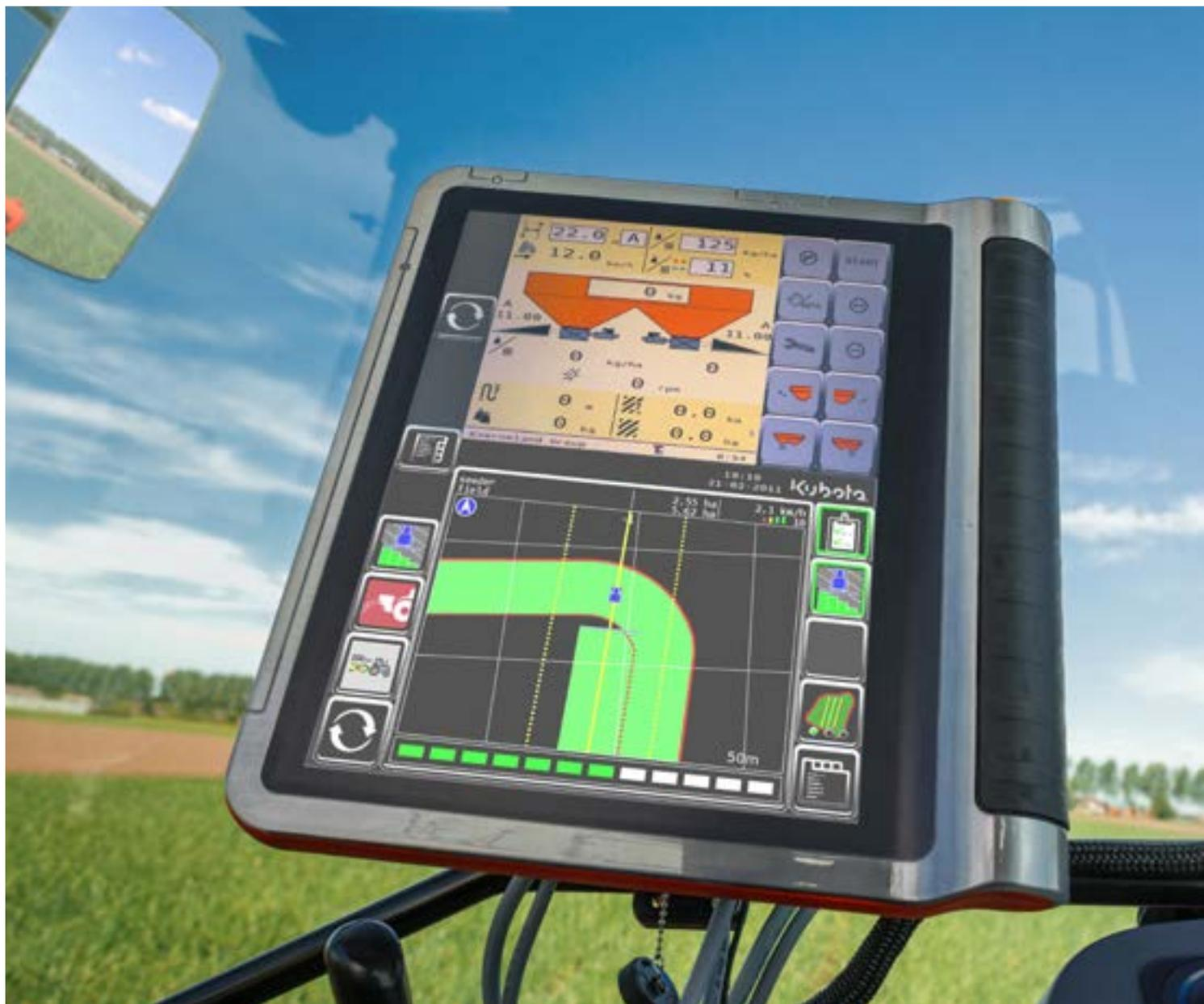
I kit di adattamento consentono di trasformare un trattore M5001N in un trattore ISOBUS per portare l'efficienza delle lavorazioni a un livello superiore. Inoltre, consentono di utilizzare qualsiasi apparecchiatura ISOBUS disponibile sul mercato.
