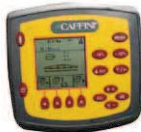
**Computer "Compact"**: Computer automatico di ultima generazione gestito da flussometro. Lo schermo retro-illuminato fornisce allo stesso tempo: litri ettaro in erogazione al momento, litri già erogati, ettari trattati, velocità di avanzamento, litri residui nel serbatoio, visualizzazione delle sezioni/in lavoro
