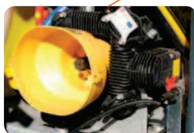
Pompa di 180 l/min a 4 membrane con grande portata, per un'agitazione ottimale del prodotto nel serbatoio durante il trattamento.
