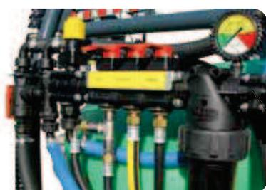
Doppia pressione. sistema innovativo, il quale permette di avere allo stesso tempo 2 pressioni differenti : bassa pressione per il trattamento, alta pressione per l'agitazione, premixer, ecc.
